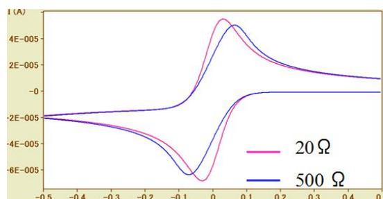
この辺の事情をシミュレーションで示すと右図のようになる。電子移動速度が速い系( $k_s = 0.1\text{cm/s}$ )について、未補償溶液抵抗が20Ω(赤線)と500Ω(青線)の場合について比較したものである。
