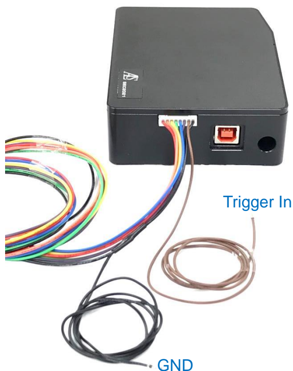
図 7-3. SEC2021 のトリガー端子
