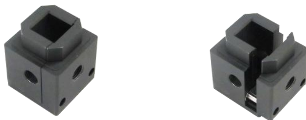
図 3-4. キュベットホルダーの側面
