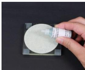
ガラス板にダイヤモンド研磨用パッドを貼り付け、研磨用ダイヤモンドを滴下する。
