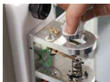
図 6-9-5. モーターを 180 度回転させ、アルミフレームの底面を綿棒などで拭きます。
