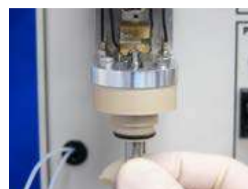
図 6-9-3. シャフトを静かに引きます。カーボンブラシでシャフトがスムーズに外れない場合、カーボンブラシのネジを緩めてください。また、ピンセットを用いて、カーボンブラシの板バネを僅かに外側に曲げてください。
