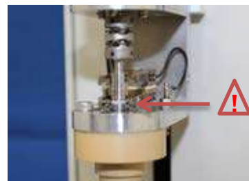
図 6-6-6. テフロンセパレータとシャフトの下側の間の隙間を通すために、リング電極用のカーボンブラシの板バネを、もう一度ピンセットで外側に曲げてください。板バネを曲げずにシャフトを持ち上げると、カーボンブラシが破損する場合があります。
