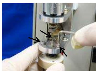
図 6-9-4. 六角レンチ(2.5 mm)を用いて、アルミフレームとベアリングの間にある 3 本の止めねじを緩め、ベアリングアッセンブリーを取り外します。
