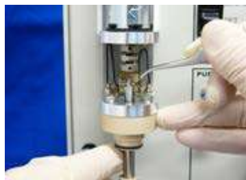
図 6-6-5. ベアリングの穴に新しいシャフトをはめ込みます。カーボンブラシの板バネをピンセットで外側に少し曲げながら注意深く持ち上げてください。板バネを曲げずにシャフトを持ち上げると、カーボンブラシが破損する場合があります。
