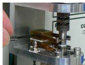
図6-5-3. 銀カーボンブラシを固定しているネジをドライバー(#000)で取り外します。 ネジが小さいため、紛失しないようご注意ください。
