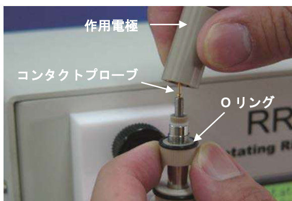
図 6-2-1. 作用電極の外し方
