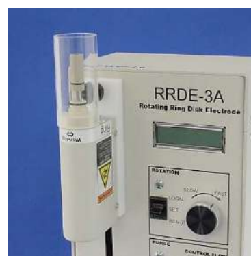
図5-6-6. スピンコートを行う準備が整った状態です。電極表面にピペット等を用いて塗布したいサンプルを滴下し、電極を回転させます。一定速度で電極を数分間回転すると、膜厚が一定な電極を作ることができます。
