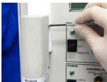
図 6-6-8. カバーをかぶせ、ネジ 4 本をそれぞれドライバー (#1 or #2) で取り付けます。
