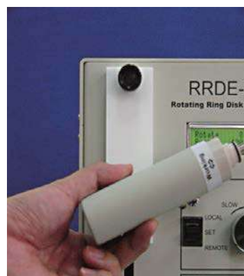
図5-6-3. モーターシャフトを、180°回転します。
