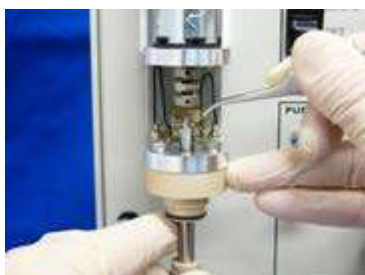
図 6-9-7. 新しいシャフトをベアリングの穴にはめ込み、カーボンブラシの板パネをピンセットで外側に僅かに曲げながら注意深く持ち上げます。
