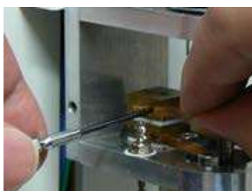
図 6-5-5. 銀カーボンブラシのネジをドライバーで固定します。
