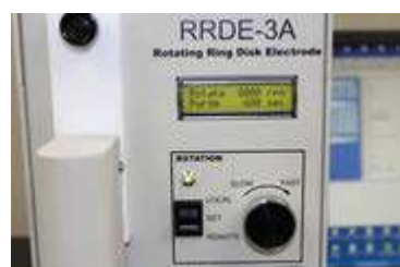
図 6-5-7. 銀カーボンブラシとシャフトの間の抵抗を小さくし、回転中の騒音を低減するために、8000 rpm で10 分間回転させてください。
