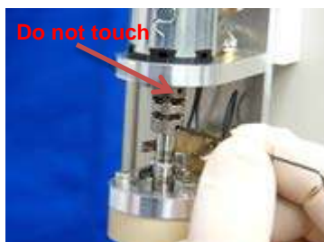
図 6-6-2. カップリングのシャフト固定ネジ(下側 2 つ)を、六角レンチ (0.89 mm = 0.035 inch.) で緩めてシャフトの固定を外します。
