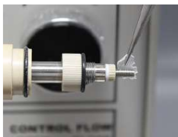
図 6-8-2. 熱収縮チューブを剥離するように取り外します。
