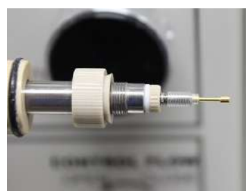
図 6-8-6. プローブを取り付けます。
