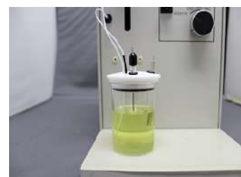
図3-8-3. 参照電極・カウンター電極・パージ用チューブをテフロンキャップに固定します。
