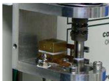
図 6-5-4. 銀カーボンブラシを取り外し、新しい銀カーボンブラシに交換します。
