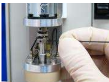
図 6-6-7. シャフトをカップリングに差し込んだら、ネジ 2 本を六角レンチ (0.89 mm = 0.035 inch) で固定します。必要ならばカーボンブラシは後で固定して下さい。
