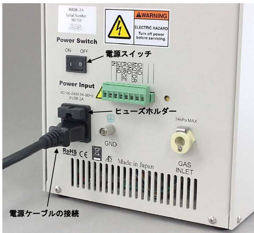
図 3-6-1. 電源ケーブル接続
