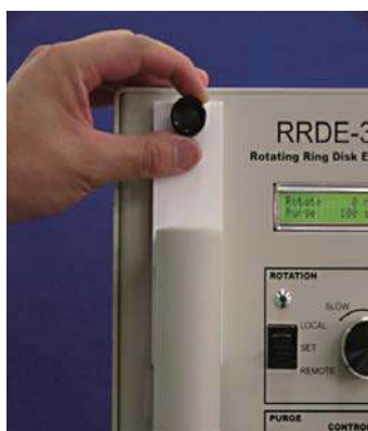
図5-6-2. モーター固定板を上部に移動し、位置設定ノブを固定します。
