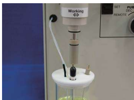
図3-8-4. 作用電極を回転させながら位置設定ノブを緩めてモーターシャフトを下ろし、作用電極を溶液に浸漬させます。
