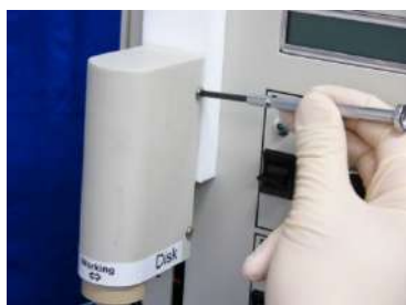
図 6-5-1. RRDE-3A のモーターシャフトカバー側面のネジを、ドライバー(#1 or #2)を用いて外します。
