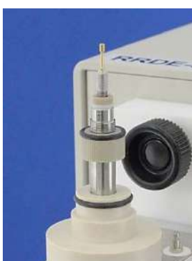
図5-6-4. 180°回転すると、コンタクトプローブが現れます。コンタクトプローブは先端が尖っていますので、取り扱いに注意して下さい。この先端にRDE、RRDEを取り付けます。
