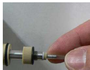
図 6-8-3. 新しい熱収縮チューブをシャフトの先端に取り付けます。
