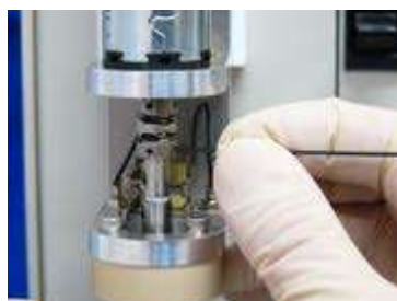
図 6-9-8. カップリングの下側にある 2 本の止めねじを六角レンチ(0.89 mm = 0.035 インチ)で締めます。その後、カーボンブラシを元に戻します。
