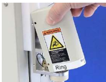
図 6-5-2. モーターシャフトからカバーを取り外します。
