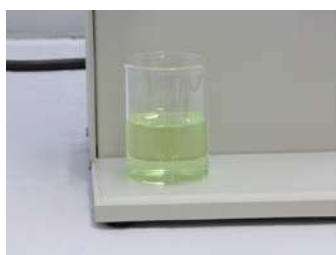
図3-8-1. 電解セルをシリコンシートの上に置きます。サンプルはピペットを用いて簡単に注入できます。
