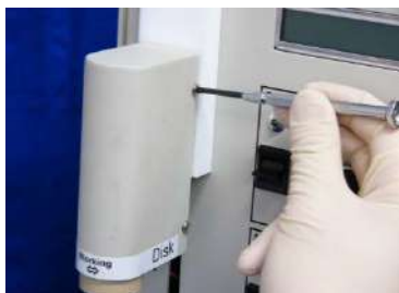
図 6-6-1. カバーを固定している 4 つのネジをドライバー(#1 or #2)で外し、カバーを取り外します。
