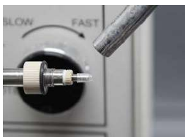
図 6-8-4. シャフトをヒートガンまたはドライヤー(150°C)で包むようにチューブを収縮させます。
