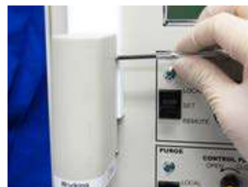
図 6-5-6. モーターシャフトカバーを再度ネジで取り付けます。
