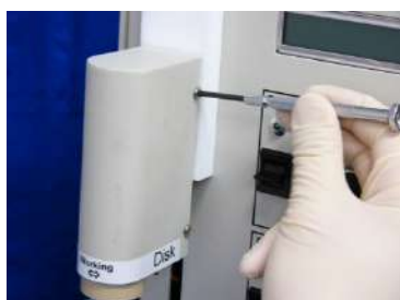
図 6-9-1. カバーを固定している 4 つのネジをドライバー(#1 or #2)で外し、カバーを取り外します。
