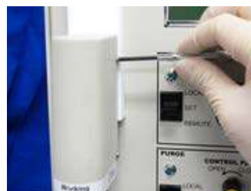
図 6-9-9. モーターシャフトをカバーで覆い、ドライバー(#1 or #2)を用いて 4 本のネジで固定します。
