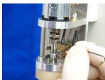
図 6-9-2. カップリングのシャフト固定ネジ(下側 2 つ)を、六角レンチ (0.89 mm = 0.035 inch.)で緩めてシャフトの固定を外します。
