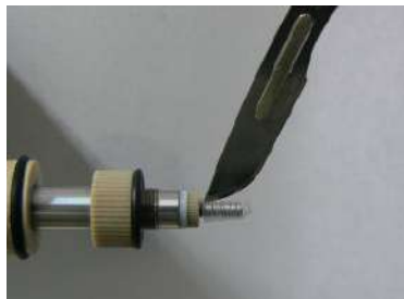
図 6-8-1. プローブを取り出した後、熱収縮チューブをナイフで切断します。
