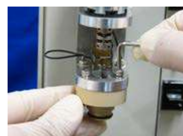
図 6-9-6. モーターを元の位置に戻し、新しいベアリングアッセンブリーを慎重に六角レンチで取り付けます。ベアリングアッセンブリーのねじ山は脆いため、ネジを締めすぎないで下さい。
