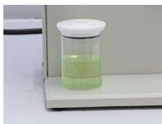
図3-8-2. 電界セルにテフロンキャップをセットします。
