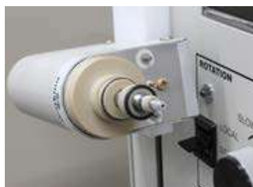
図 6-7-5. 新しいプローブをシャフトに差し込みます。
