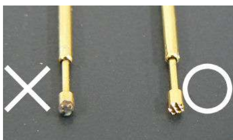
図 6-7-1. 腐食したプローブ(左)
