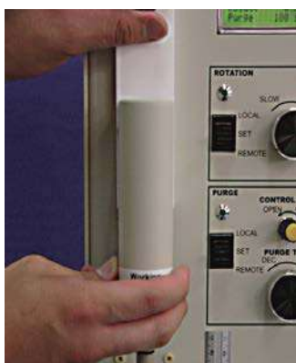
図5-6-1. 位置設定ノブを緩め、テフロンプレートを上方向に移動します。
