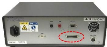
図 2-1 ALSモデルの25-pinセルコントロール端子
