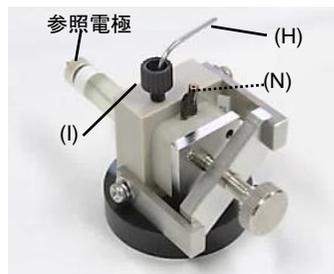
4. クロスフローセルブロック(A)に参照電極(別売)、フィッティング(I)、カウンター電極用ステンレスパイプ(H)を取り付けます。更に測定条件に応じて、作用電極の接続口にデュアル電極ジャンパーコネクタ(N)を取り付けます。
