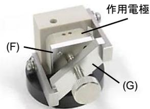
3. 電極面をガスケット側に向けた作用電極(別売)を、クロスフローセルブロック(A)に取り付けます。更に電極固定板(F)を被せ、クランプ(G)で固定します。
