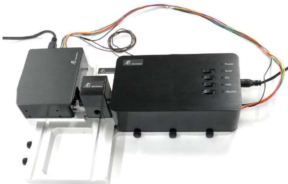
図 5 :光源の配置と接続ケーブル
