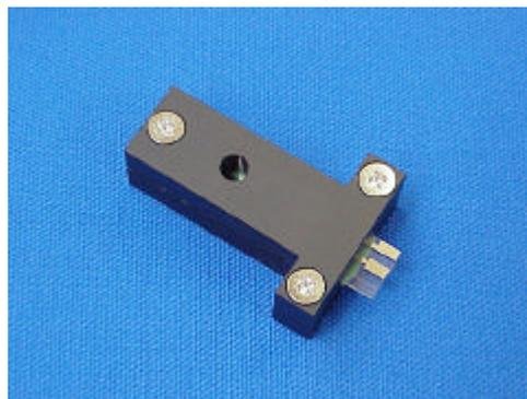
分光電気化学セルを分光セルホルダーに入れ、電極をポテンシostatに接続しセットアップを完了させます。
