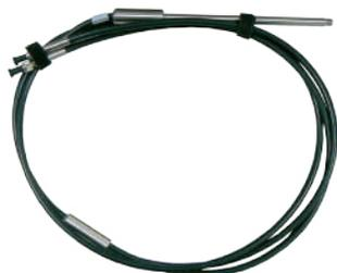
溶液浸漬プローブは2分岐しており、それぞれスペクトロメーターと光源に接続します。プローブ部分を溶液に直接浸し、溶液の透過光・吸光度を測定します。D300LMは300 μmファイバーが2本で構成されています。1本は光照射用、もう1本は測定用ファイバーとなります。プローブ先端には光路長チップを取り付けます。光路長別にチップがラインナップされており、2、5、10、20 mmから選択できます。
