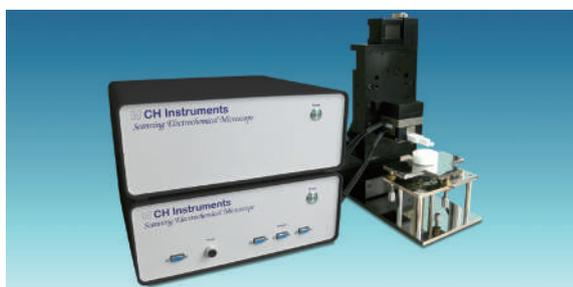
走査型電気化学顕微鏡 (SECM) は界面近傍の化学的な変化を高解像度で観察するための装置です。サンプル表面の近傍をスキャンして微小探針で起こる反応を画像化します。SECM は表面の化学物質の反応像、反応速度の定量が可能です。腐食研究、細胞膜の研究、液液界面の研究に用いられています。
