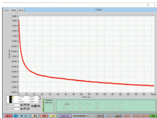
図 9-1. 2 mM フェロシアン化カリウムの定電位分解
