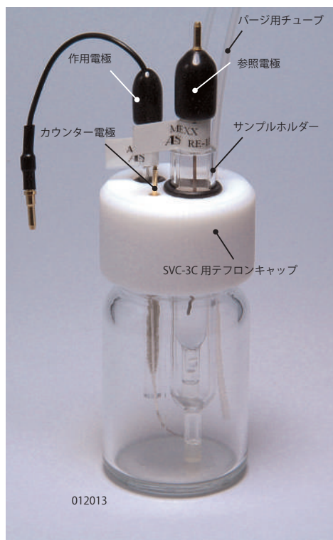
作用電極、参照電極は別売りです。作用電極は、微小電極タイプをご使用ください。
